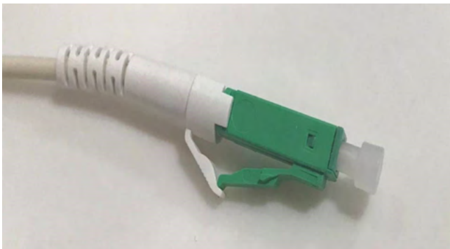
Abbildung 18: Glasfaserstecker Typ LC-APC (DIN EN 61754-20). Quelle: Deutsche Telekom
